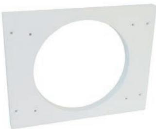
Um kleinere Kernbohrungen auch für die Lüfter Typ 100- 150 sowie 100-230 zu verwenden, gibt es Adapterplatten, die auf das vorhandene Loch zentrisch montiert werden. Diese bestehen aus einem 21mm wasserfestem Material. Die Platte besitzt 8 Bohrungen. Auf die inneren Bohrungen wird der Lüfter montiert. Mittels 4 Spax wird nun der Lüfter auf die Platte montiert.
