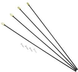
Der Schraubensatz beinhaltet vier Gewindestangen sowie ein Schraubenset zur Montage der Lüfter. Er wird benötigt zur Überwindung der Wandstärke bei Kernbohrungen. Max. Wandstärke: 45cm. Mittels Schraubenset sowie Gewindestangen werden der innere Teil des Lüfters (Motor) mit dem äußeren Teil (Abdeckung) miteinander gegenseitig verschraubt. Pro Lüfter wird ein Schraubensatz benötigt.
