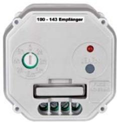
Nicht nur der Außensensor kann mit Funk betrieben werden, sondern auch alle Lüfter. Hierzu benötigen Sie das Sendefunkmodul Typ 100-141, welches wir für Sie bereits in die Steuerung einbauen. Für die Lüfter benötigen Sie je Lüfter einen Empfänger. Dieser wird bei Aufputzmontage in Kellern in einer Abzweigdose untergebracht.
