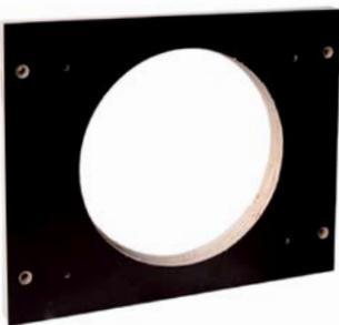
Um kleinere Kernbohrungen auch für die Lüfter Typ 100- 150 sowie 100-230 zu verwenden, gibt es Adapterplatten, die auf das vorhandene Loch zentrisch montiert werden. Diese bestehen aus einem 21mm wasserfestem Material. Die Platte besitzt 8 Bohrungen. Auf die inneren Bohrungen wird der Lüfter montiert. Mittels 4 Spax wird nun der Lüfter auf die Platte montiert.
