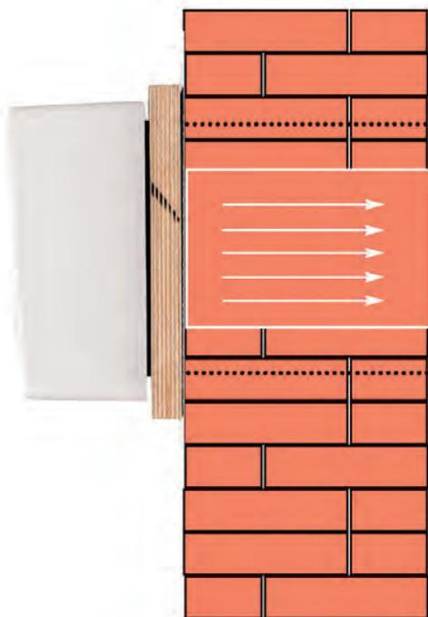
In vielen Kellern sind bereits Kernbohrungen vorhanden, jedoch nicht immer mit dem geforderten Durchmesser für die Lüfter. Um diese Kernbohrungen auch für die Lüfter Typ 100-150 sowie 100-230 zu verwenden, gibt es ab sofort eine Adapterplatte, die auf das vorhandene Loch zentrisch montiert wird.
